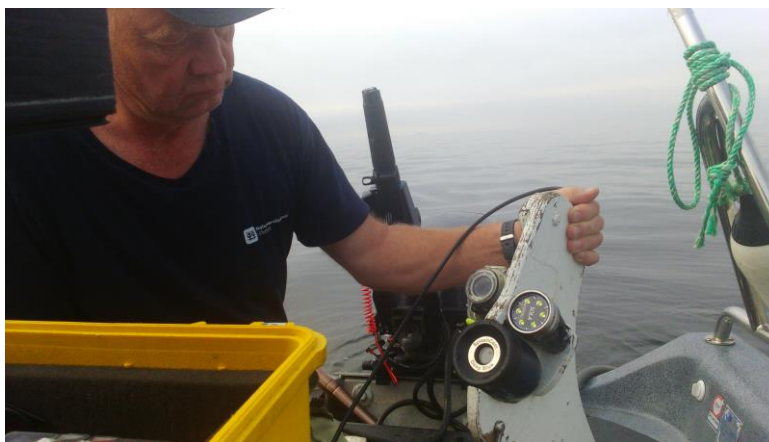
Figur 3. Styreplata (towfish) med 2 videokamera samt lyskilde. Foto: Per-Erik Schultze.
