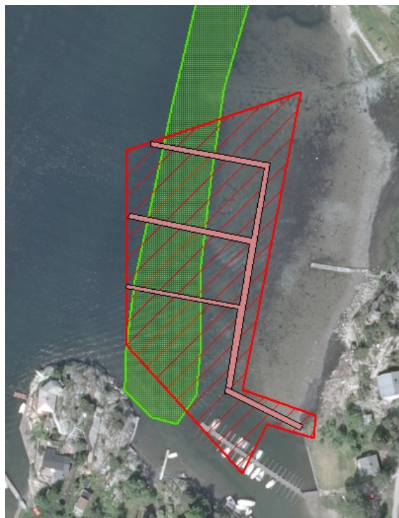
Fig. 3. Arealet med rød skravur viser et utsnitt av den delen av planområdet som er regulert til bryggeanlegg. Bryggas utforming er antydnet med lyserødt. Grønn skravur angir forekomsten av ålegresseng.
