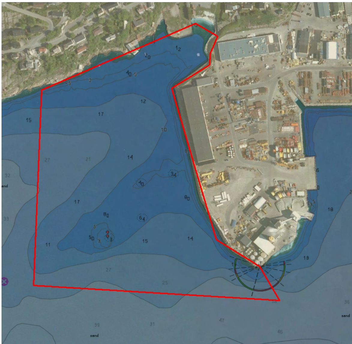
Fig. 3. Dybdeforholdene innenfor planområdet varierer fra ca.40 m og opp til tørt land. De bratteste gradientene finnes sør i området hvor det stedvis er loddrette bergvegger under vann. Dybdene på kartet er angitt i meter.
