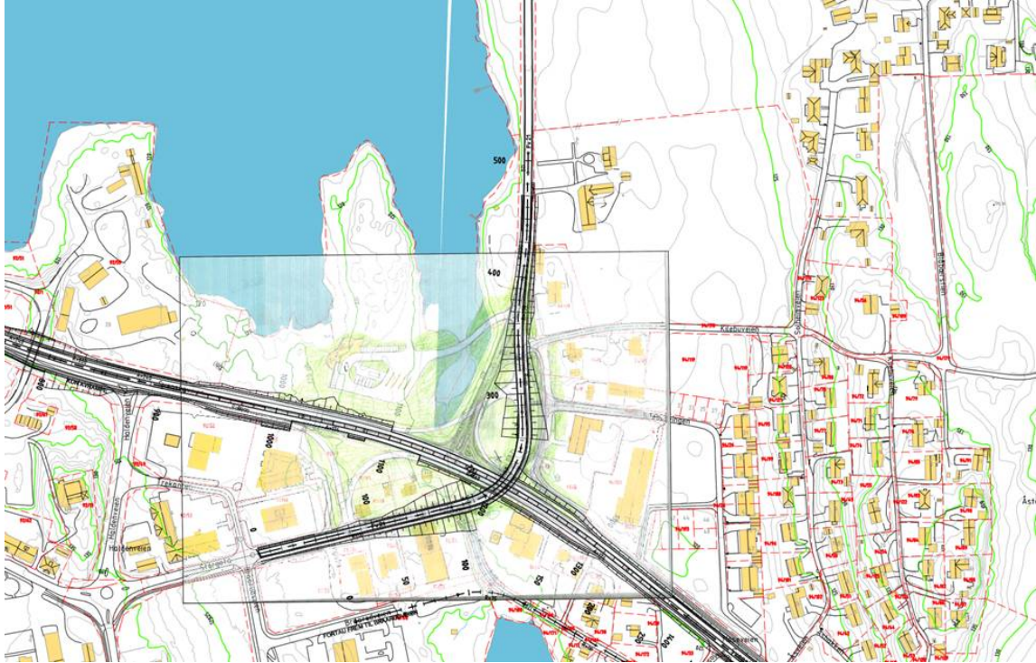
Fig. 2. Den planlagte veien krysser vika på en kombinasjon av fylling og bro/kulvert og fører ut til parkeringsplassen på Brårudtangen. Kryssningspunktet kan skimtes midt i øvre halvdel av den markerte firkanten i tegningen.
