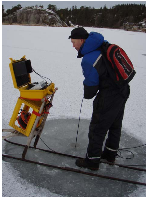
Fig 4. Feltarbeidet ble utført med videokamera operert gjennom hull i isen. Foto: Kjell Magne Olsen
