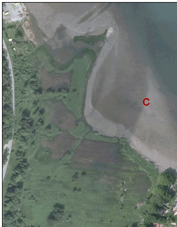
Fig. 3. Beitemarka på Ravneng, eller Teglverkstomta som den også kalles. Områdene hvor det ble tatt ut leire til teglproduksjonen framstår i dag som fuktenger og sees på bildet som noe gråere enn de tørrere engene omkring.
