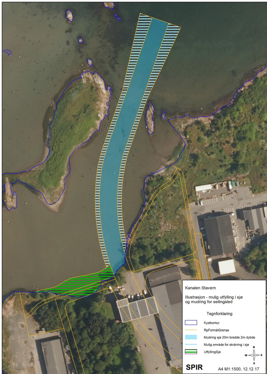
Figur 3. Kanalen som skal mudres for at mindre båter skal kunne seile fra utbyggingsområdet og nordover i Agnesbukta.
