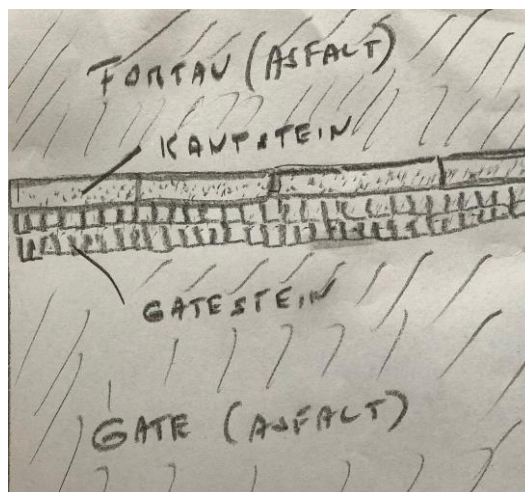
Figur 4. Skisse til en mulig plassering av gatestein for å skape et egnet habitat for brokkurt ved rehabiliteringen av Grimkells gate.
