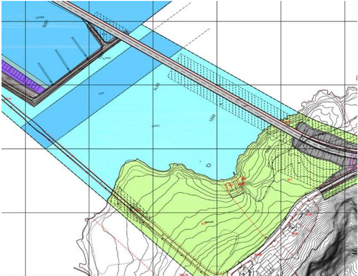
Figur 2. Plankartet viser eksisterende bru i sør-vest og den nye brutraseen i nordøst. Svart stiplet og loddrett skravur viser arealet som vil bli fylt ut med stein.
