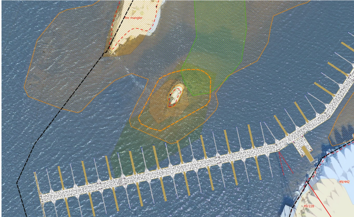
Figur 3. Skissen til den nye brygga er lagt over et georeferert dronebilde tatt den 13.9.2023 samt sjøkartet. For å gjennomføre tiltaket vil det være nødvendig å fjerne det lille skjæret på nordsiden av den prosjekterte brygga. Den oransje ringen omkring skjæret antyder grovt det arealet som må fjernes for å få seilingsdybde for båt plassene nærmest skjæret. Som det går fram av figuren er skjæret omgitt av et gruntvannsområde. Arealet som må fjernes (ca. 300 m 2 ) ligger i sin helhet innenfor den nyregistrerte lokaliteten med naturtypen Bløtbunnsområder i strandsonen (brun skravur). En mindre del (ca. 60 m 2 ) av den nyregistrerte lokaliteten med naturtypen Ålegraseng og andre undervannseger (grønn skravur) vil også bli berørt av fjerningen av skjæret. Planområdet er vist med svart stiplede linje. Dronefoto ved WK Naturkart.
